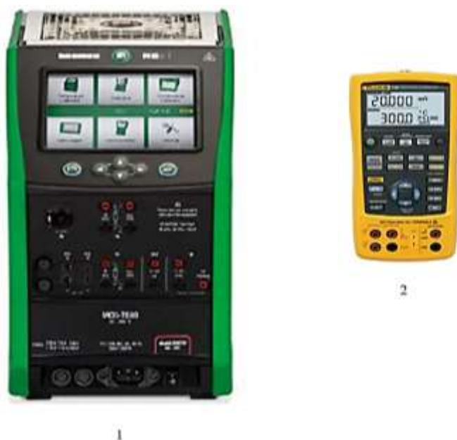
Рис. 2. Универсальные калибраторы (калибраторы процессов): с термостатом и компрессором – 1, без термостата и компрессора – 2
