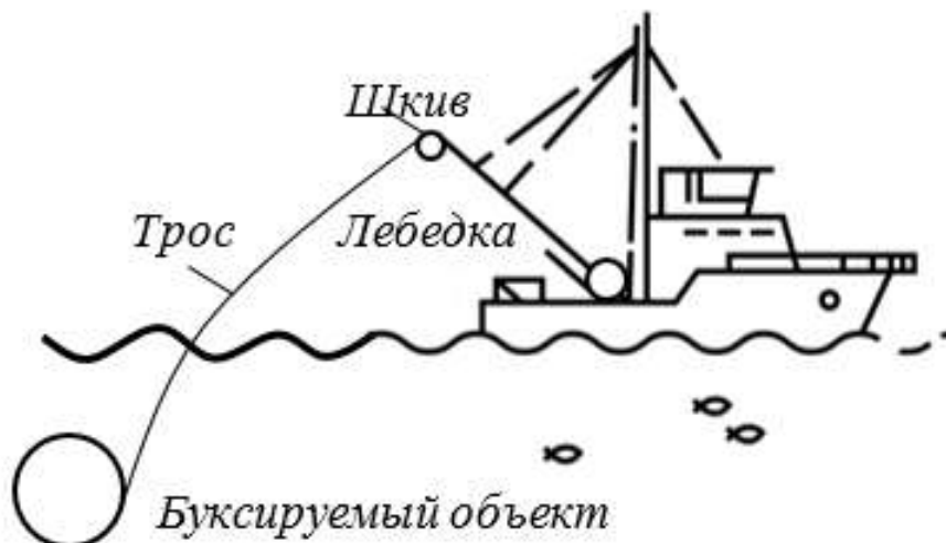
Рис.1. Система «судно – лебедка – трос – буксируемый объект»
